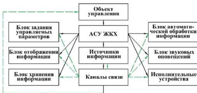
Рисунок 1 – Элементы структуры автоматической системы управления жилищно-коммунальным хозяйством
